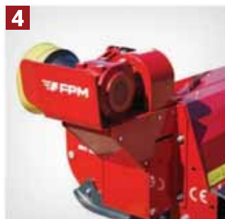
MULTIPLIKATOR osiguran robusnom zaštitom, nalazi se na spoljnoj strani
