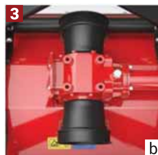
MULTIPLIKATOR sa jednosmernom spojnicom: a) Zadnje kačenje (standardno); b) Samo prednje ili kombinovano prednje i zadnje kačenje (opcija)
