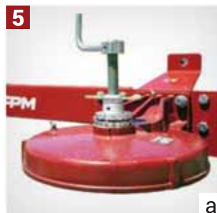
PODEŠAVANJE VISINE RADA: a) podešavanjem visine preko kinematske glave; b) podešavanjem visine točkova
