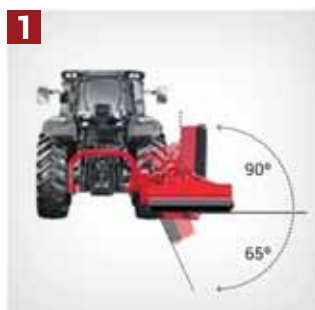
VERTIKALNO POMERANJE Od -65° do +90°
