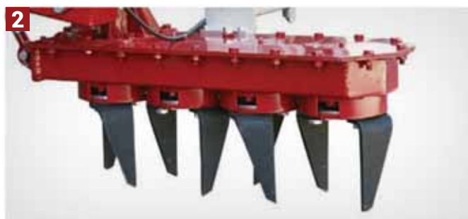
VERTIKALNI RADNI ORGANI omogućavaju bolju obradu zemljišta
