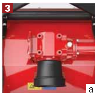
MULTIPLIKATOR sa jednosmernom spojnicom: a) Zadnje kačenje (standardno); b) Samo prednje ili kombinovano prednje i zadnje kačenje (opcija)
