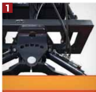
HIDRAULIČNI SISTEM sa zaokretom do \pm 30^\circ
