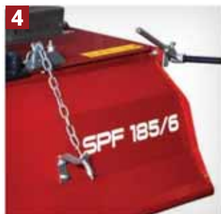
4 ZADNJI POKLOPAC Podešavanjem položaja podešava se stepen usitnjenosti zemljišta
