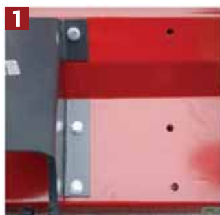
PRIKLJUČNI RAM mogućnost bočnog pomeranja u dva položaja
