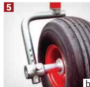
PODEŠAVANJE VISINE RADA: a) podešavanjem visine preko kinematske glave; b) podešavanjem visine točkova
