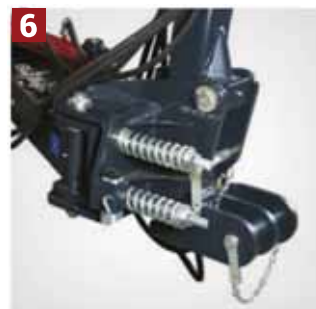
SIGURNOSNI MEHANIZAM sa oprugama, omogućava u naletu na prepreku trenutni pomak bočnog mulčara. Time je omogućen siguran prelaz preko prepreke
